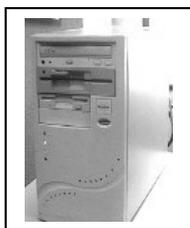
**El CPU** es el gabinete que aloja, el mainboard (la placa central de la computadora.), donde está conectado el procesador (chip), el disco rígido, la disquetera interna, el cd-rom, la memoria y todas las otras placas, como por ejemplo la placa de sonido, la de video, el módem, etc.
